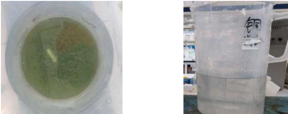
图 2-3 铜去除小试实验中（左）与沉淀后（右）
