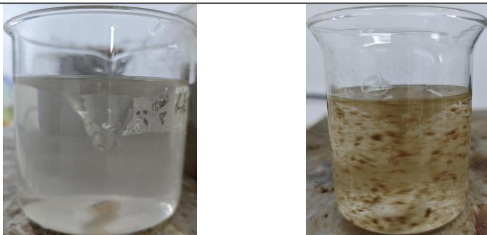
图 2-5 破氰实验中（左）与混凝沉淀后（右）
