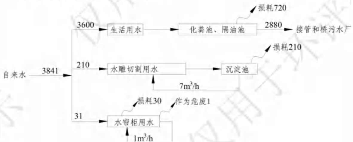
图 2-1 改扩建项目用排水平衡图 (t/a)
