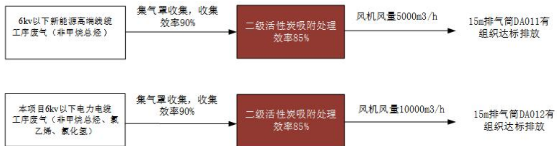
图 4-1 废气处理工艺流程图
