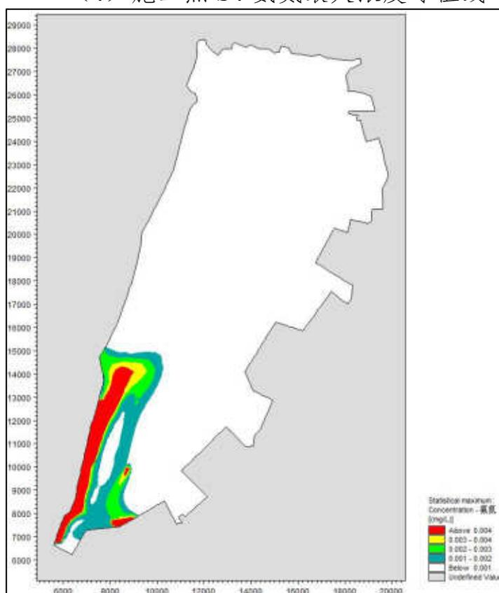
(5) 施工点 S1、S2、S3、S4 同时施工氨氮最大浓度等值线
