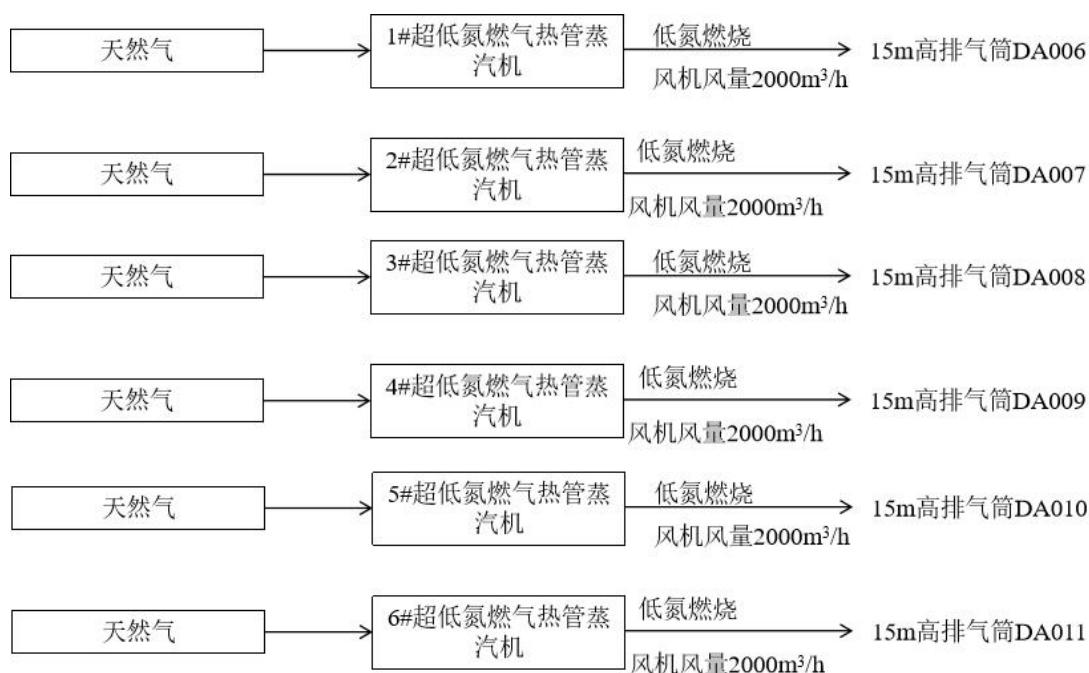
图 4-1 本项目废气收集及处理措施图
