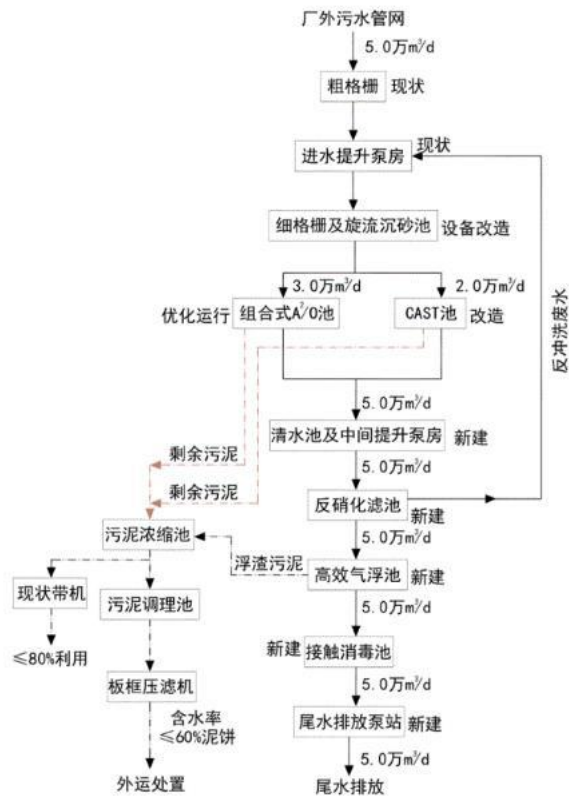
图 4-2 污水处理厂污水处理工艺流程图
