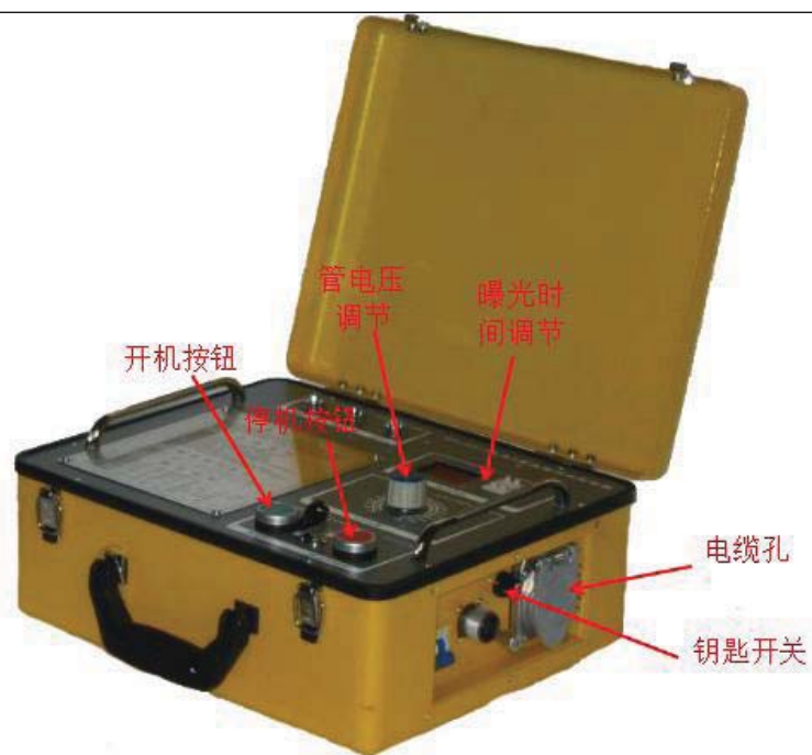
图9-2 常见X射线探伤装置控制台
