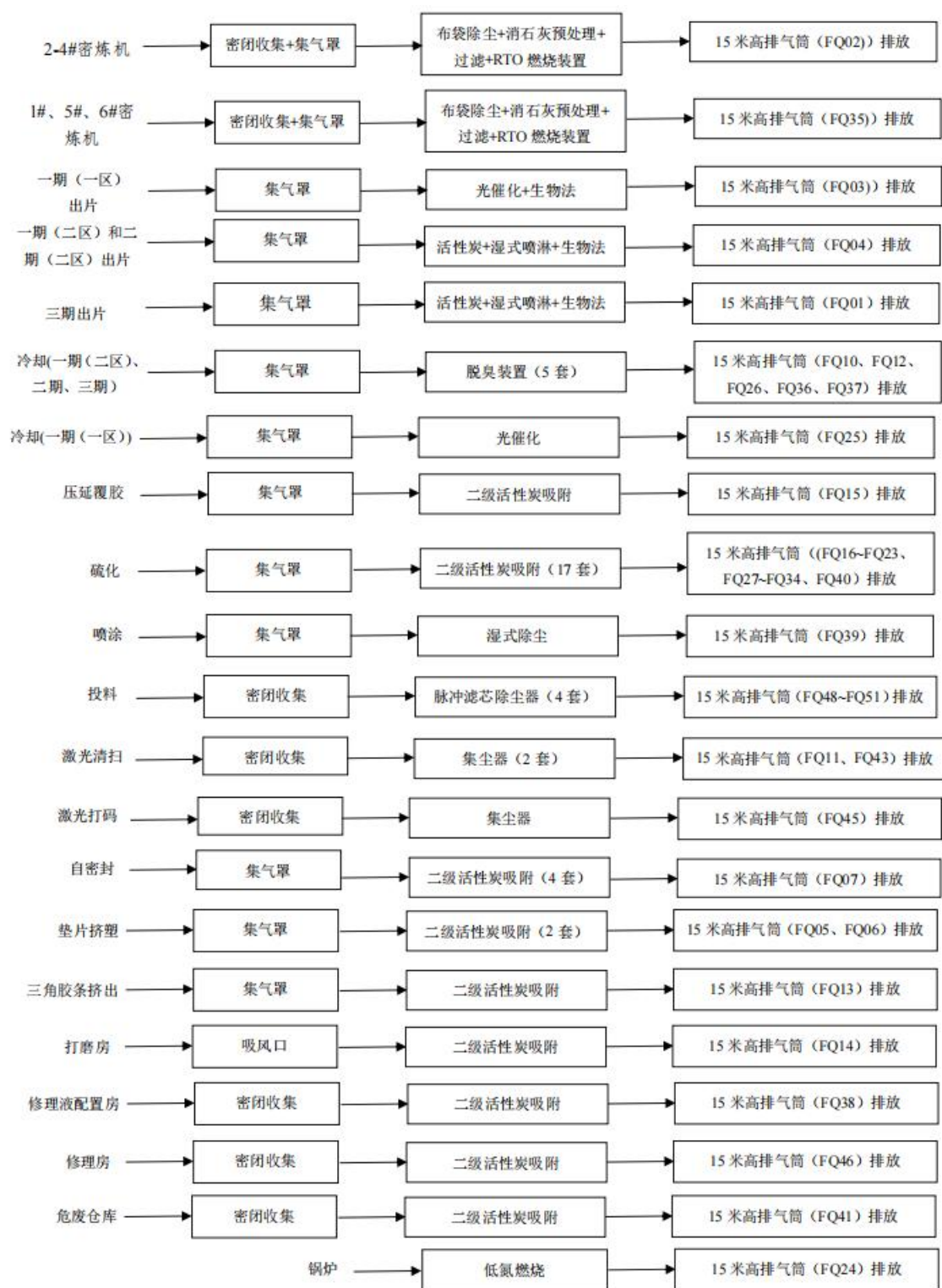
图 3.1-5 现有项目废气收集处理系统图
