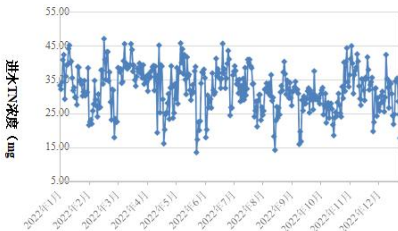
图 2.1-8 洛社污水厂进水 TN 变化曲线图
