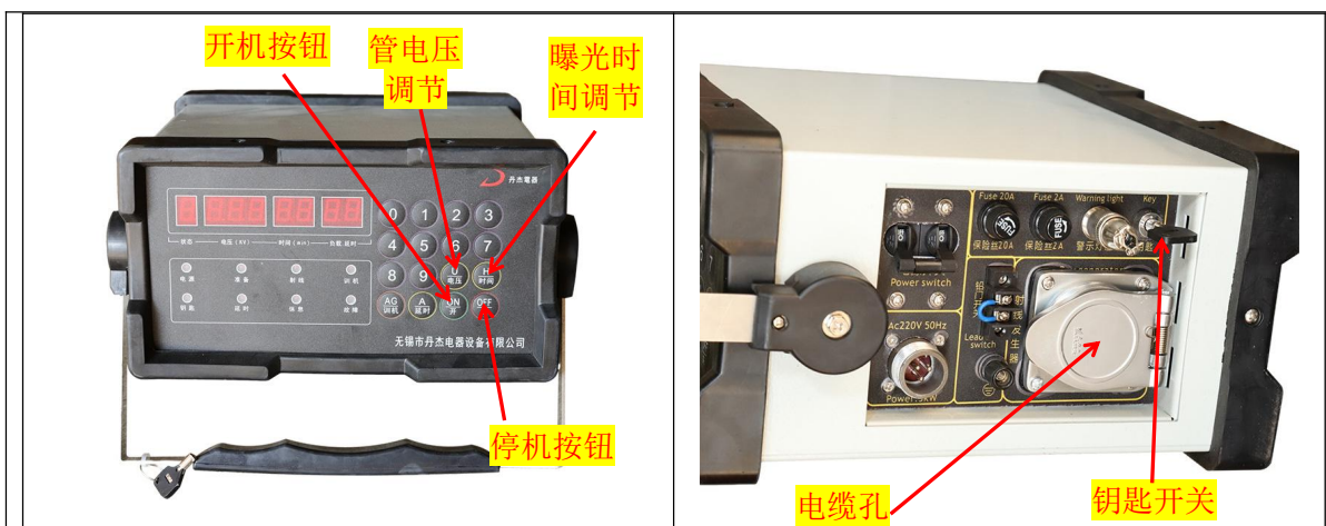
9-1 常见X射线探伤装置控制箱
