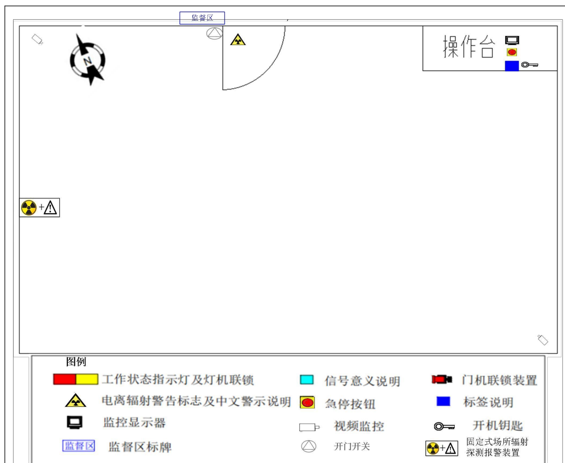
图 10-2 本项目辐射防护措施图
