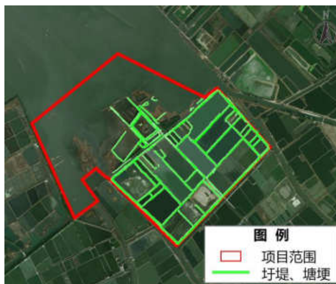
图 3.1-5 项目区域圩堤、塘埂现状
