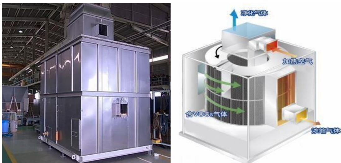
图 6.2.1-6 分子筛转轮装置图
