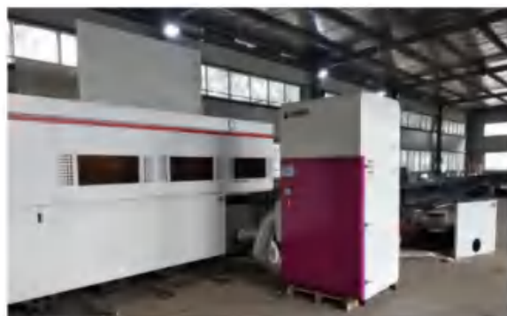
图 4-5 本项目激光废气净化器安装效果示意图
