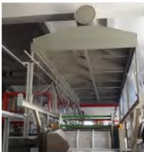
图 4-7 电化学抛光槽、钝化槽上部伞形罩+软帘示意图
