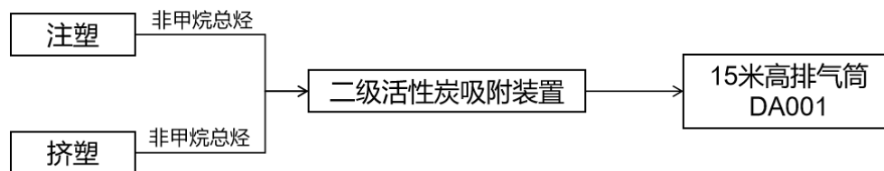
图 4-1 生产车间废气处理工艺流程图
