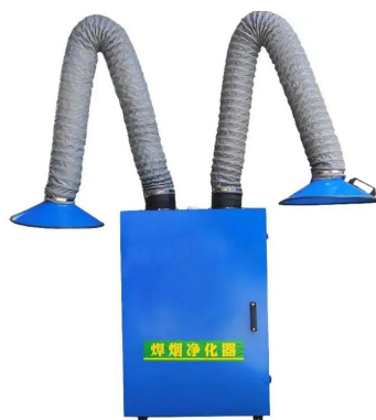
图 4-4 移动式烟尘净化器装置图
